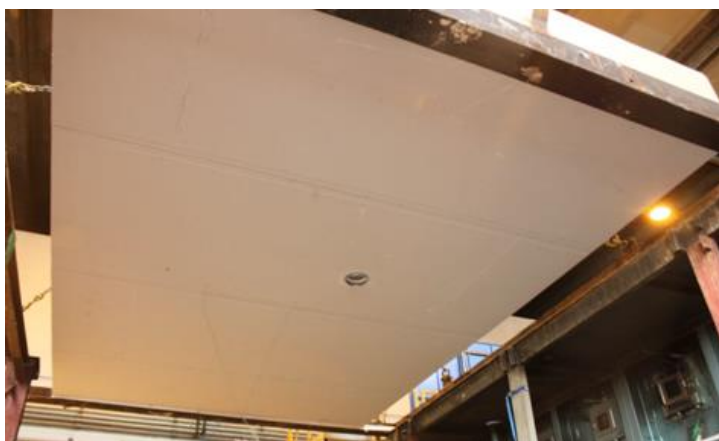
Bilde: Underside av etasjeskiller klar for branntest. Foto: RISE
