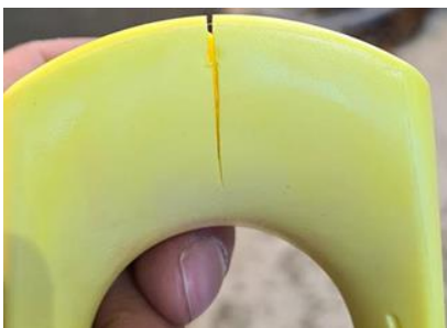
Bilde: Ødelagt adapter etter testing i VITEC AS hydrauliske testmaskin.
